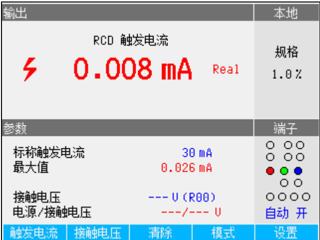
图 13.RCD 触发电流显示
