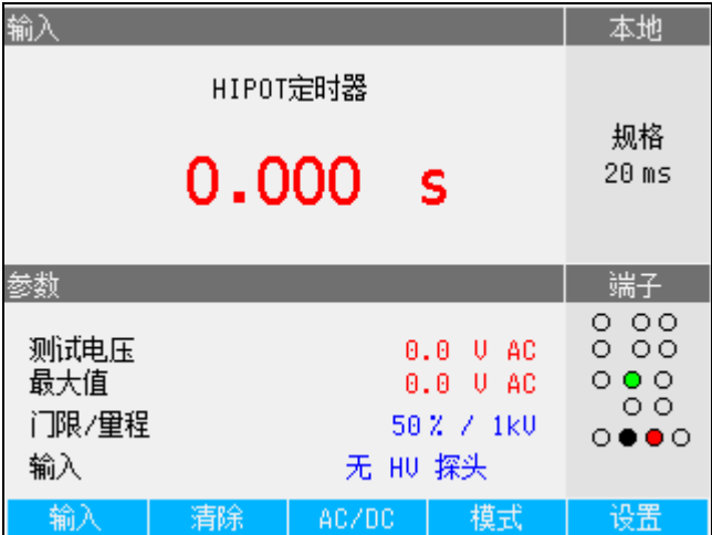
图 26.执行 Hipot 计时器测量时的万用表显示
