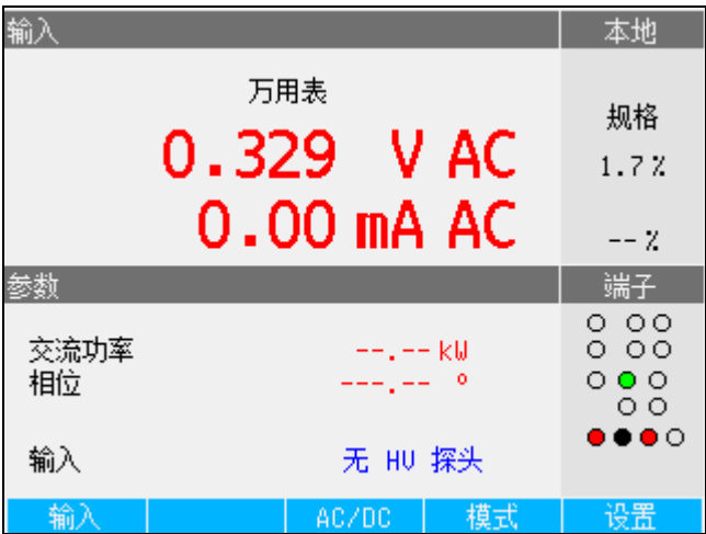
图 22.电表输入设置为直接测量最高 5 kV 电压并启用 HV 端子
