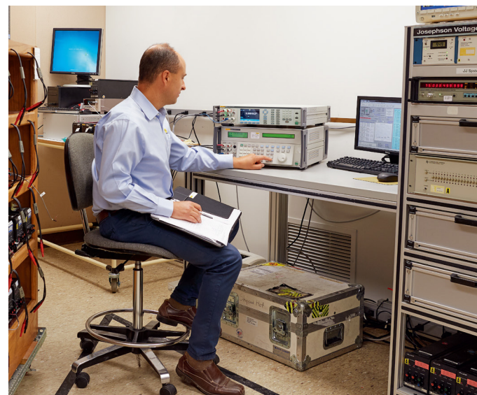
交流电压测量设置
