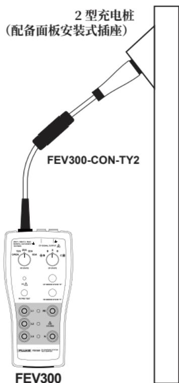
图 7. 测试适配器连接 2 型插头
