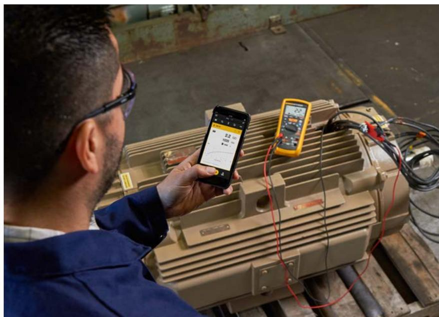
使用 Fluke 1587 FC 及 Fluke Connect 测量应用程序存储并共享数据。
