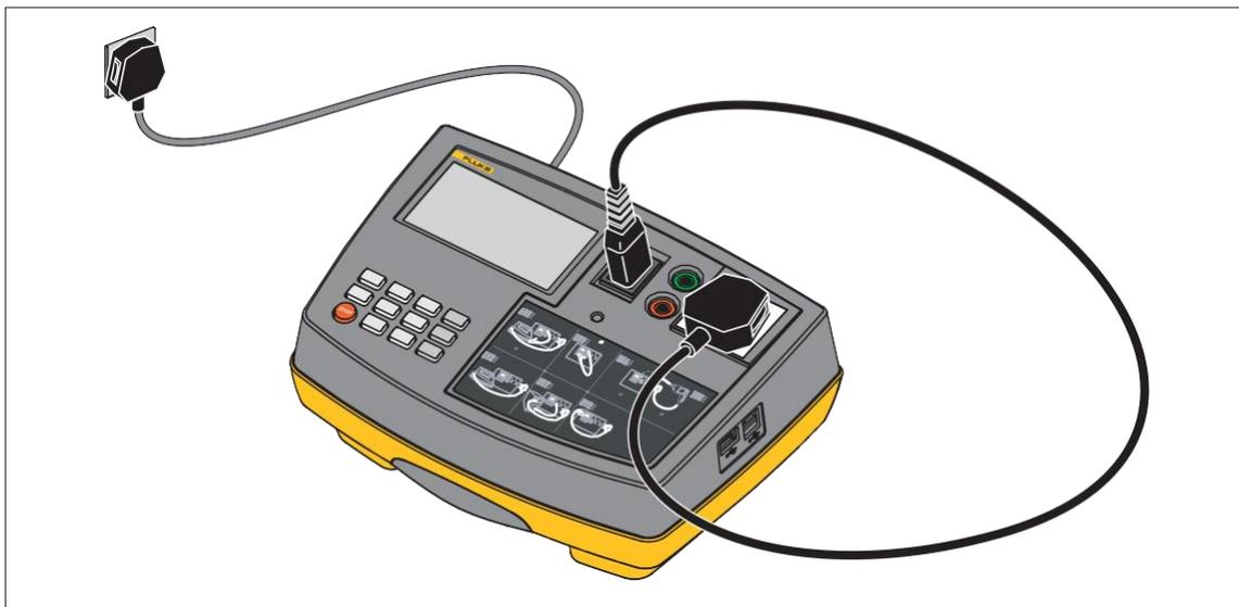
图 6 IEC 导线测试连接
