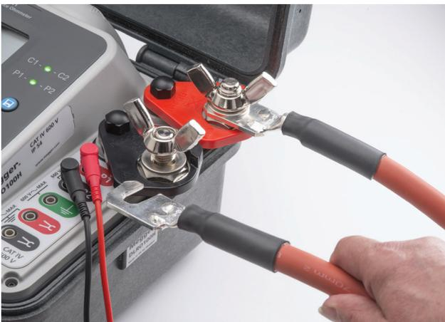
新型终端适配器设计用于确保可使用用户自己的测试引线。
