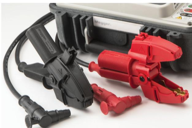
新型的坚固可调夹头设计用于确保多种应用时的灵活性，可以更好地与测试件连接。
